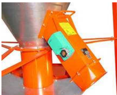
опционално: електрически изход на смесителя - патент "Грубер"
